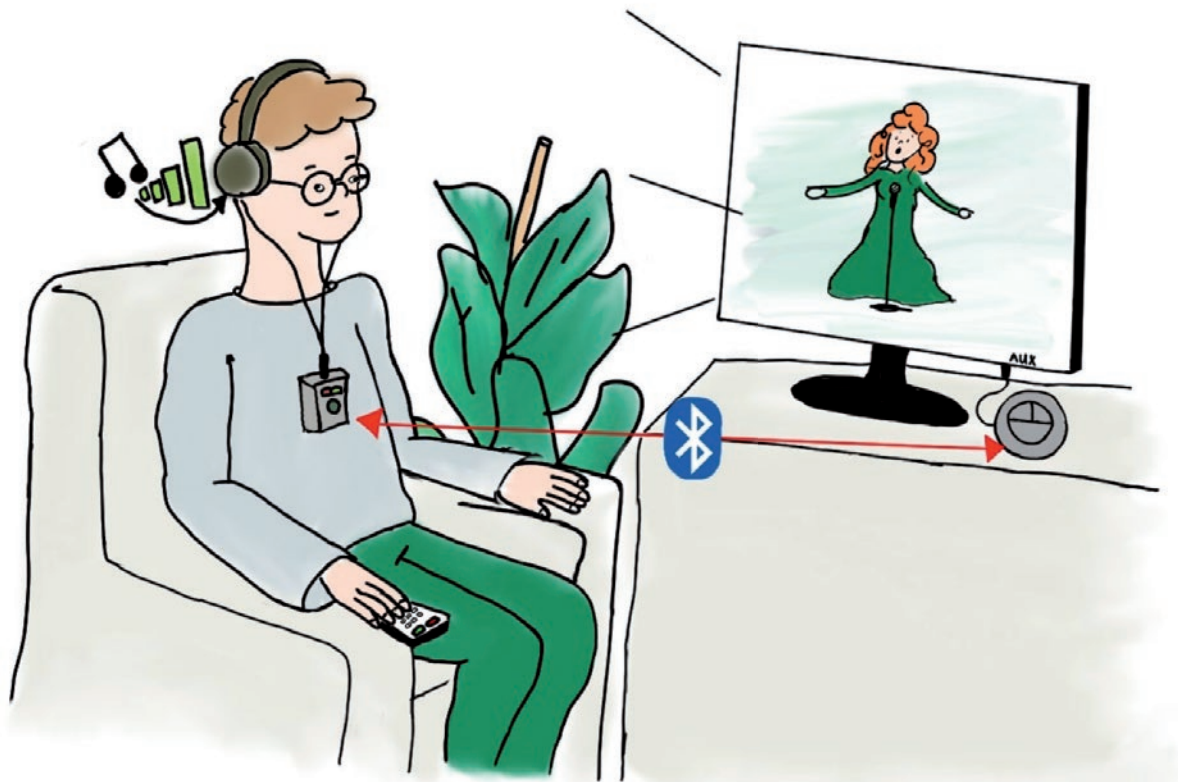
Figuur 2 Man met doofblindheid gebruikt solo-apparatuur (zender, ontvanger, hoofdtelefoon) tijdens TV kijken.
